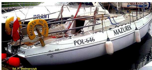
S/y Mazurek - sloop bermudzki, długości 9,51m, zbudowany w Gdańskiej Stoczni Jachtowej im. J. Conrada, którego głównym konstruktorem był Wacław Liskiewicz.
