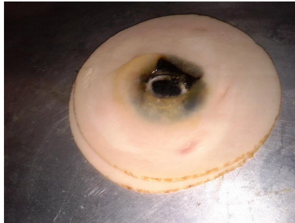
Fot. 4. Skutki zetknięcia się baterii z powierzchnią organiczną (plastry szynki). Eksperyment przeprowadziła Komisja Europejska podczas Międzynarodowego Dnia Bezpieczeństwa Produktów odbywającego się w Brukseli w dniach 16-20 czerwca 2014 roku.
