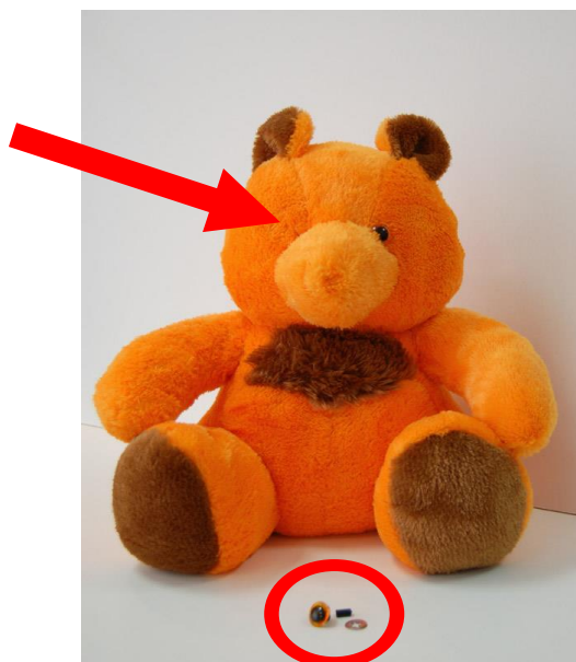
Fot. 3. Odpadające małe elementy z zabawki przeznaczonej dla dzieci poniżej 36 miesiąca życia.
