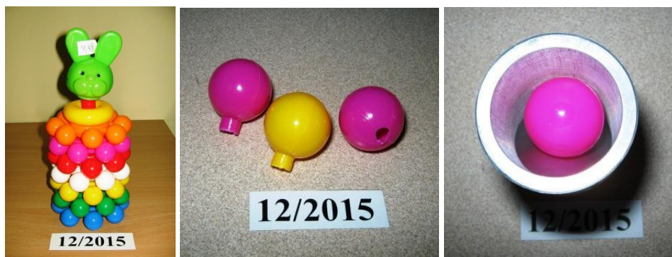
Fot. 4. Małe elementy, które oddzieliły się od zabawki przeznaczonej dla dzieci poniżej 36 miesiąca życia w trakcie badania laboratoryjnego, całkowicie mieszczące się w cylindrze do badania małych części. Małe części stwarzają ryzyko udławienia lub uduszenia w przypadku połknięcia przez dziecko.
